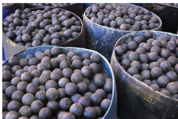
Bolas de molienda de acero utilizadas en Miguel Auza
